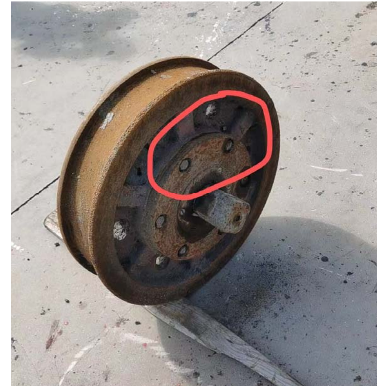
轴承压盖松动变形有缝隙漏水
